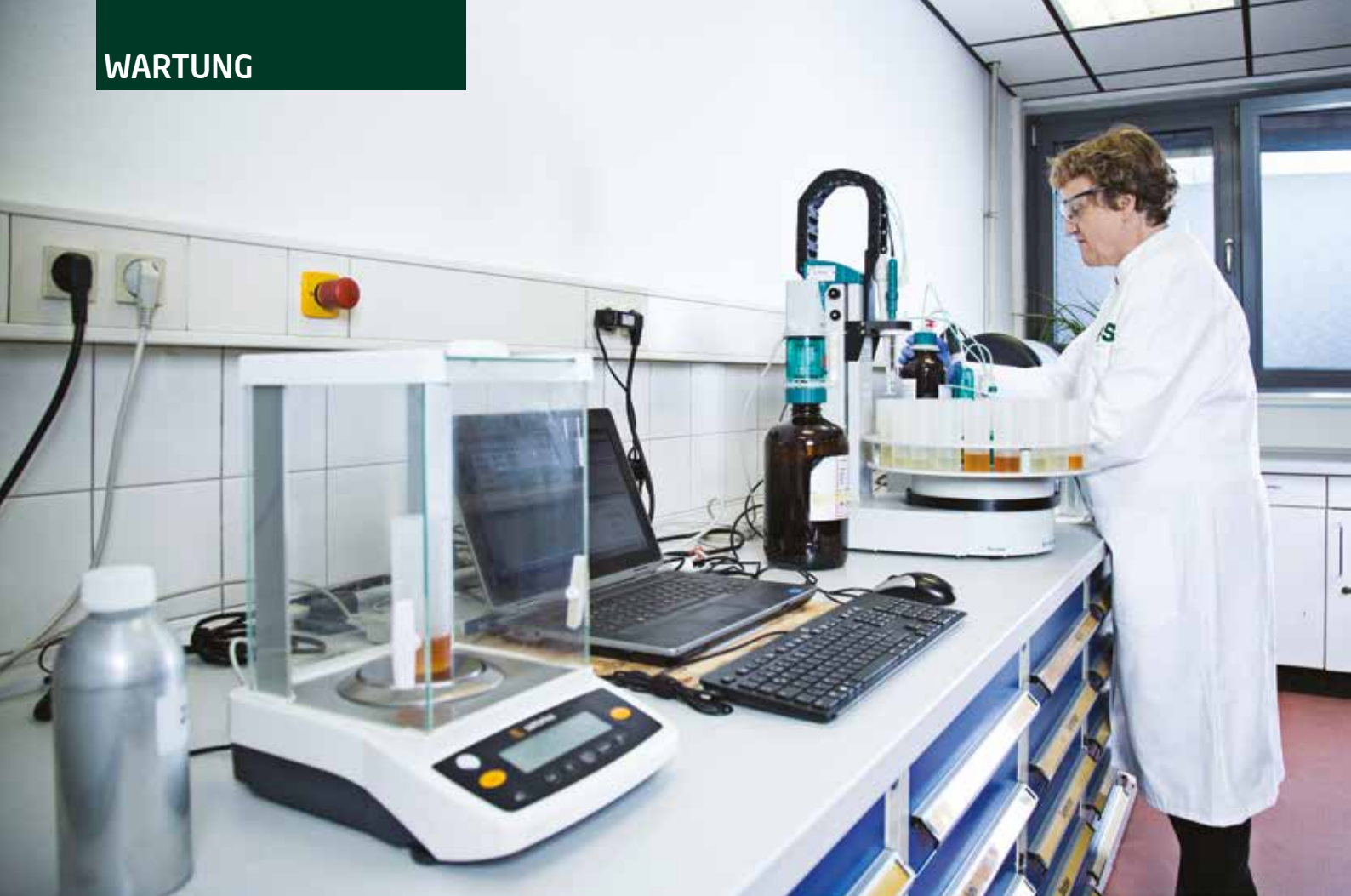
In den EOS eigenen Laboren können verschiedene Parameter analysiert werden, um die Qualität des Isolieröls zu beurteilen.
