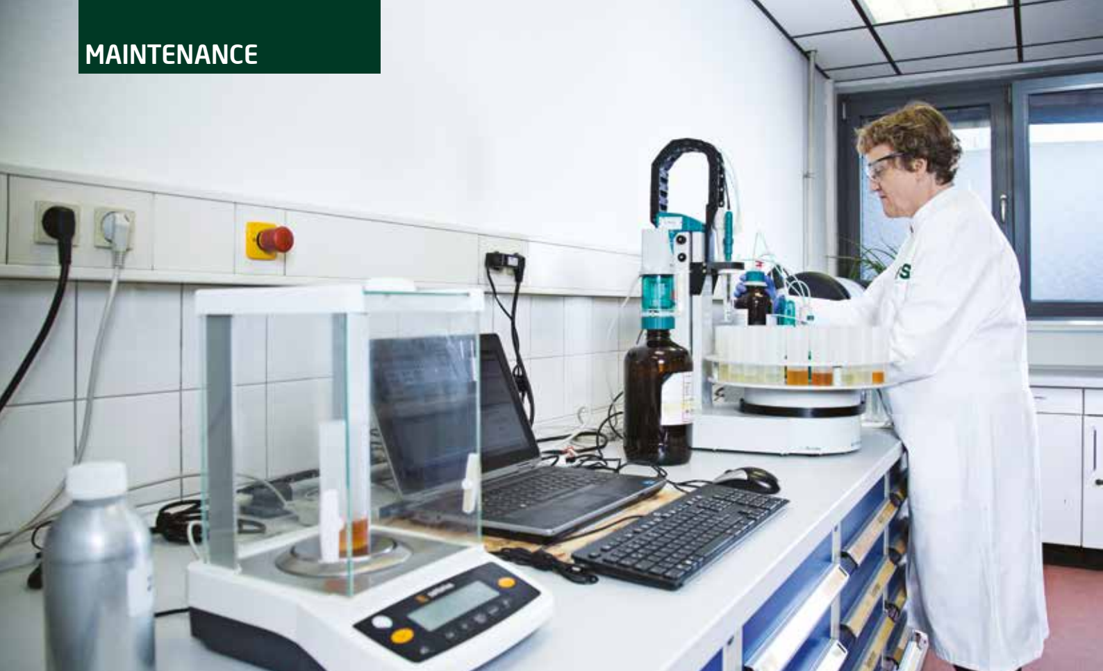
Le propre laboratoire d'EOS permet de tester différents paramètres afin d'évaluer la qualité de l'huile isolante.
